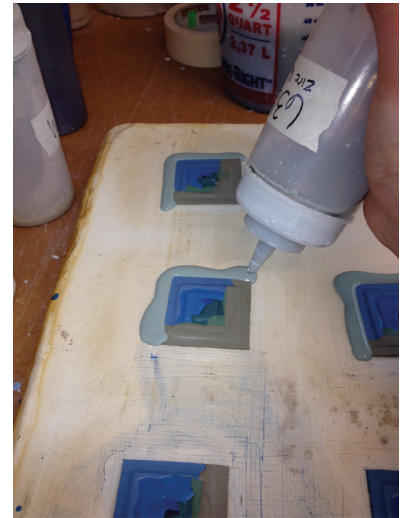
pouring a layer of slip
